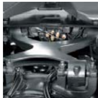
X-образный рычаг на задней оси выполняет функцию стабилизатора и треугольного рычага подвески
