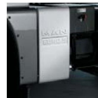
Глушитель с катализатором SCR для выполнения Евро 5.
