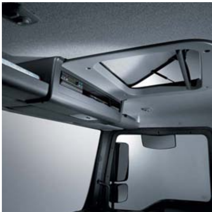
Отсек для хранения над лобовым стеклом и люк на крыше в кабине типа С
